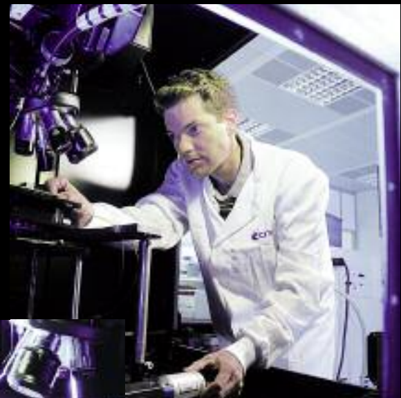
(8) Cette fois le composant endommagé est ausculté sous un microscope à balayage laser. Le but : localiser le défaut avec une extrême précision.
