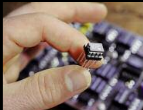
(2) Les électroniciens placent un socket en place du composant « présumé coupable » pour commencer les investigations. Leurs gestes sont comptés : le nombre d'intervention sur une carte modèle de vol est limité pour ne pas endommager les circuits.
