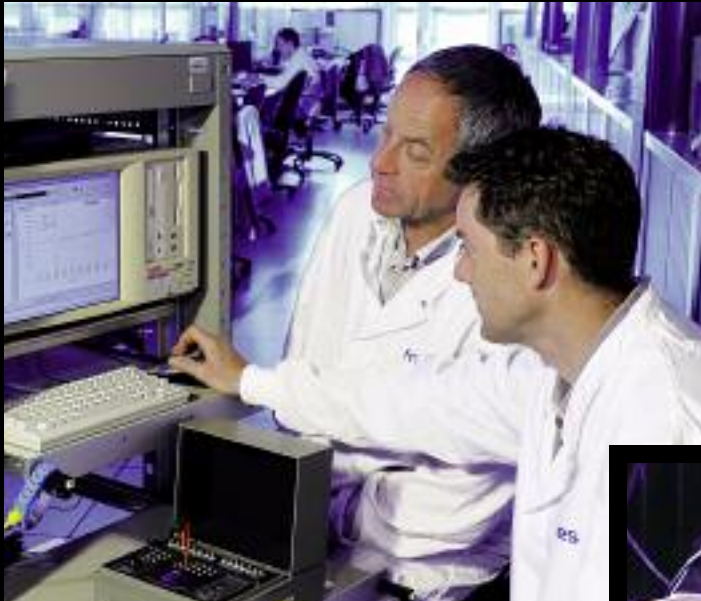
(7) Après une première observation optique du PWM, Jean Garnier et Kevin Sanchez utilisent une machine traceuse de courbe pour tester électriquement le composant. Le court-circuit est confirmé.
