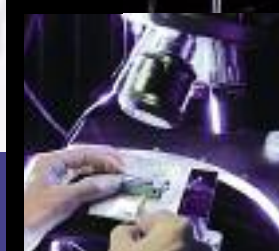
(7) Après une première observation optique du PWM, Jean Garnier et Kevin Sanchez utilisent une machine traceuse de courbe pour tester électriquement le composant. Le court-circuit est confirmé.
