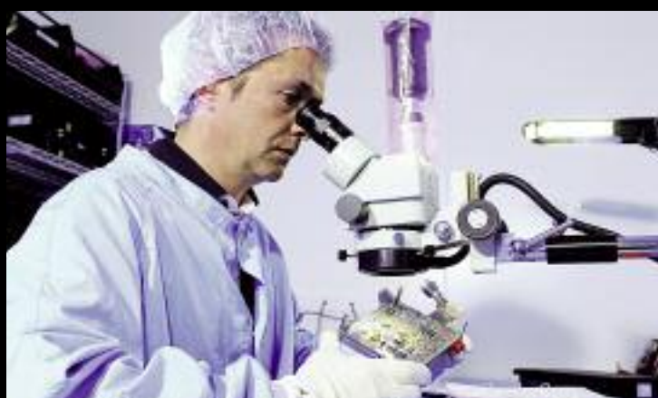
(6) Une des premières expertises consiste en une inspection visuelle minutieuse de la carte électronique à l'aide d'une binoculaire grossissant jusqu'à 40 fois. Le but : détecter des défauts technologiques ou la présence de corps étrangers à l'origine de la panne. Dans notre cas, Thierry Battault ne décèle rien d'anormal, visible à l'œil et sous binoculaire...
